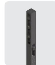
Distribución luminosa para áreas donde es importante dirigir la luz en profundidad y anchura, muy habituales en plazas y patios. El sistema óptico tiene un haz de apertura de  $40^{\circ}$ , ideal para áreas de hasta 2,75 veces la altura de la luminaria. Para una columna de 350cm tenemos una distribución de 9,60m y para 500cm, 14m.
