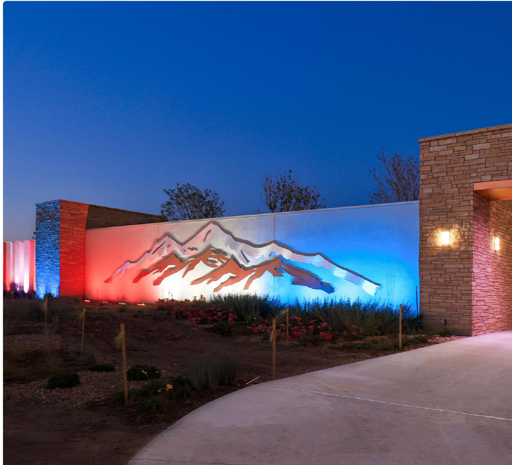
La gama de exteriores Jedi Compact Outdoor añade la versión RGBW tanto en instalación empotrada como en proyector de superficie. La tecnología de cuatro chips LED permite la perfecta mezcla del color en cada chip individual, para conseguir un resultado homogéneo y de alta calidad, eliminando el efecto de visión de los colores primarios antes de su combinación.
