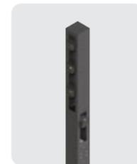
La óptica asimétrica tiene una apertura de  $60^{\circ}$ , que la convierten en la solución para iluminar planos horizontales como áreas de parking y también superficies verticales como fachadas. Ideal para iluminar áreas de hasta 2,75 veces la altura de la luminaria, de modo que la columna de 350cm tiene una distribución de 9,60m y la de 500cm de 13,75m.
